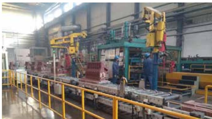
Конвейер по производству блоков цилиндров
