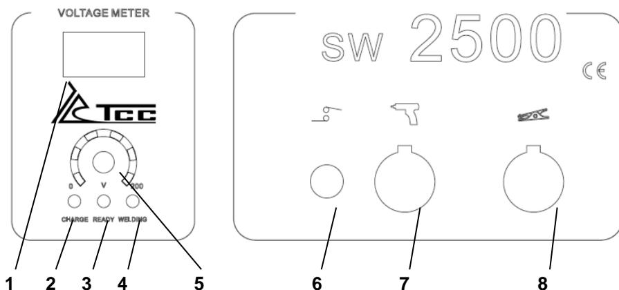
1 - Цифровой вольтметр, 2 – Зарядка, 3 – Готов, 4 – Сварка, 5 - Регулятор напряжения, 6,7 -Подключение пистолета, 8 - Обратный кабель.
